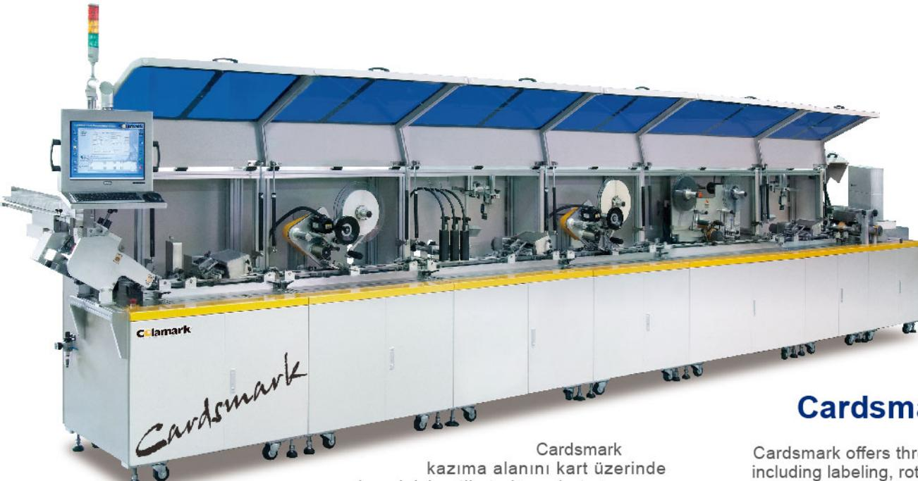
Cardsmark kazıma alanını kart üzerinde uygulamak için etiket, döner hot stamp ve flesko baskı gibi 3 alternatif bulunmaktadır. Kişiselleştirme baskısı için CIJ, TIJ ve DOD veya lazer gibi kodlayıcı seçenekleri ve modüler tasarımlı ile kazı kazan kartlarının kişiselleştirilmesi için geniş bir konfigürasyon yelpazesi sunar. Görüntüleme sistemi bilgi ve kazıma panelinin bütünlüğünü kontrol eder. Güçlü kontrol yazılımı operasyon ve bilgi işlem kontrolünün tek bilgisayar üzerinde yapılmasını sağlar.
